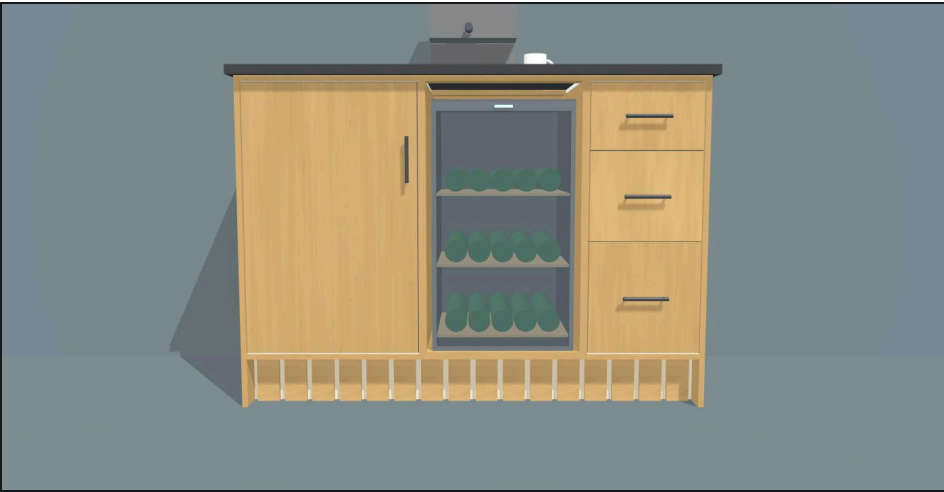
Vue de face, portes et tiroirs fermés. Les façades de portes et de tiroirs sont encastrées dans leurs ouvertures, affleurantes avec la façade du meuble.
